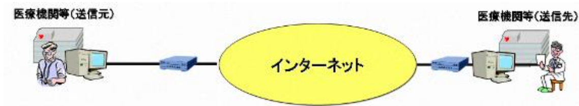
図④ オープンネットワークで接続されている場合
